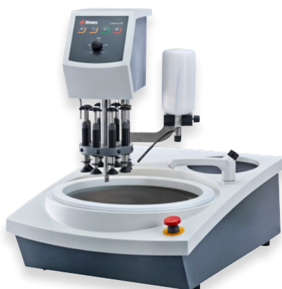
Soportes para láminas delgadas durante el lapeado y pulido
