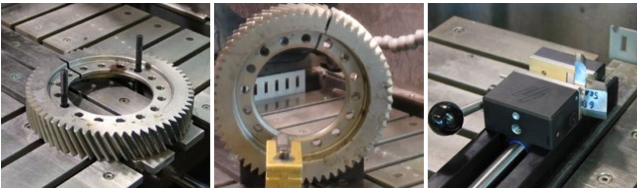
図2: 切断ホイールを挟まないようにするための特殊クランピングの使い方と、歯の表面に対して平行および垂直に切断するための固定方法
