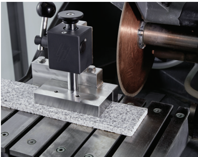
Herramienta de sujeción vertical, ideal para muestras bajas y de formas regulares.
