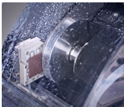
Schleifen mit Topfscheibe auf Accutom-100.
