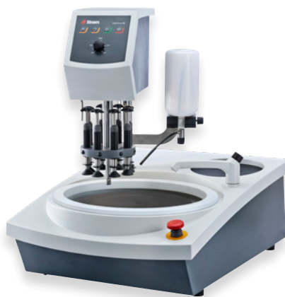
LaboForce-Mi ist ein halbautomatischer Probenbeweger zur Erstellung und zum Polieren von Dünnschliffen und polierten mineralischen Einzelproben. Durch Andruckkraft wird individuell durch Federandruck geregelt.
