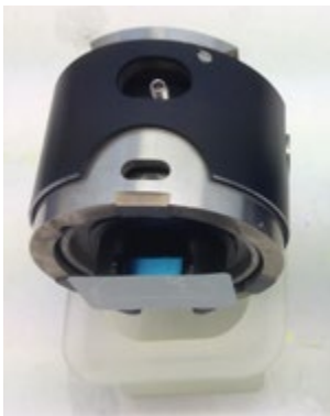
图示 3: 将样品镶嵌到样品座中。
