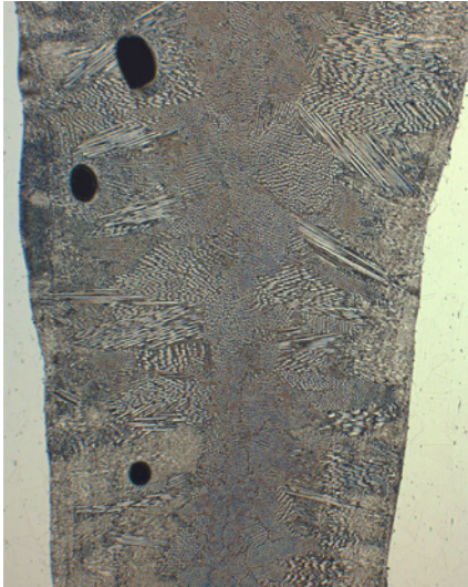
Schliff durch eine Elektronenstrahlschweißung einer Nickel-Basislegierung zeigt Stengelkristalle in der Schweißzone und einige Gasporen. Hellfeld, 50x.
