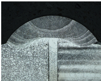
WIG Mikroimpulsschweißung einer Inconel 625 Legierung; mechanisch poliert und elektrolytisch geätzt mit 10%iger Oxalsäure, 10 Sek. mit 10 Volt. Hellfeld, 2.5x.
