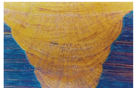
Mehrlagige Edelstahlschweißung, farbgeätzt nach Lichtenberger und Bloech. Hellfeld, 6.5x.
