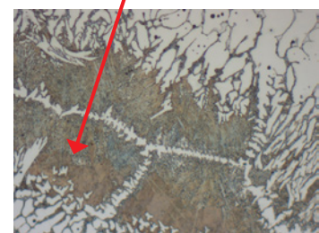
Polierter und geätzter Schliff einer Schweißung aus austenitischem Stahl. Schweißzone zeigt Inseln aus Deltaferrit und einen kleinen Bereich Perlit.
