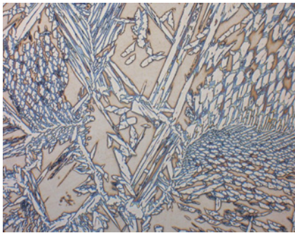
Gleicher Werkstoff, Detailansicht. Mikrogefüge der Schweißung besteht hauptsächlich aus Deltaferrit und Austenit. Hellfeld, 200x.
