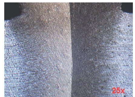
Abb. 3: Verschmelzungsnah einer Druck-Reibschweißung eines niedrig legierten Stahls. Die damit verbundene plastische Verformung und Wärmeeinflusszone sind zu sehen. Hellfeld, 25x.
