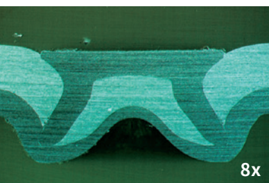
リベット継手、 アルミニウム 中の鋼リベット
