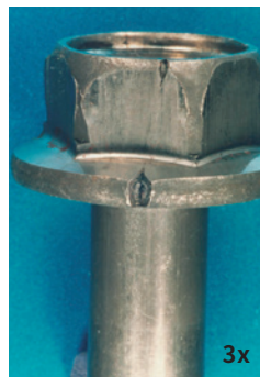
図 6A: 継ぎ目による炭素鋼ボルト頭部の分離。
