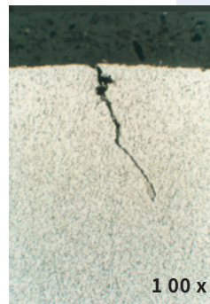
図 6b: 図7aの継ぎ目の横断面。エッチング液: 3%ナイトール
