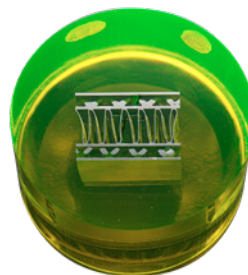
EpoDye, colorant fluorescent à mélanger avec la résine pour faciliter l'identification des pores et des fissures lors de l'examen de l'échantillon en éclairage fluorescent.
