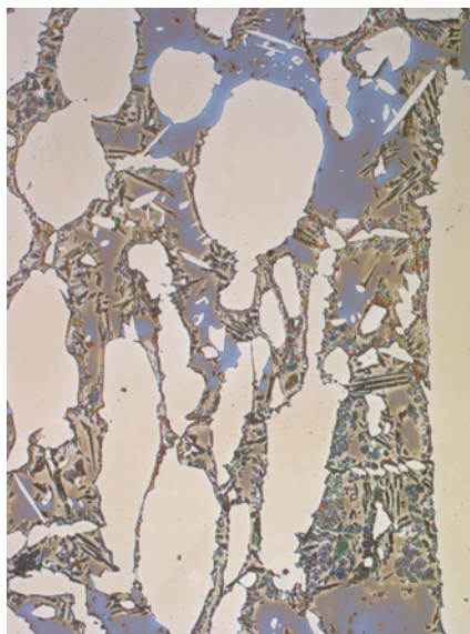
图 10: 锻造双相钢, 显示有蓝色铁素体、白色奥氏体和 \sigma 相细针, 经 40% 氢氧化钠水溶液蚀刻。
