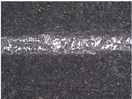
图 6: 回火马氏体不锈钢, 75x 含 \delta 铁素体, 经苦味酸蚀刻
