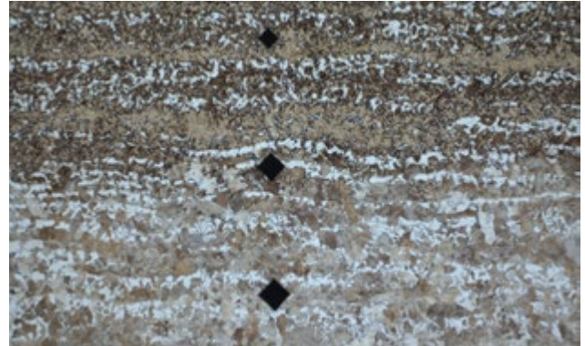
图示 1: 制备一个有一系列自动化压痕的用于硬度测试的表面。
