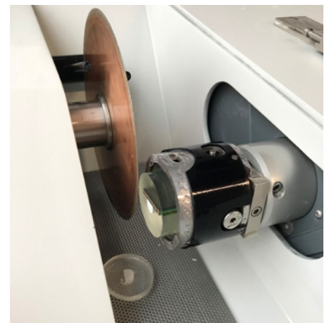
Prélèvement effectué avec la machine de tronçonnage de précision Accutom – proche de la cible et sans déformation.
