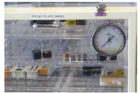
図16: 研磨済み試料をデシケーターでの保管
