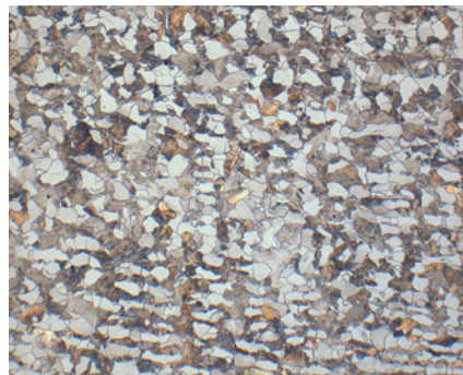
図7: 3%ナイトルでエッチングされたC45鋼。白色の相はフェライトで、残りはパーライトです。光学顕微鏡 明視野(BF)、元の倍率200 x。
