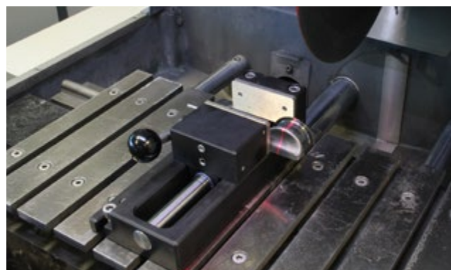
図9:最後の切断のためにベースプレートクランプで固定された状態
